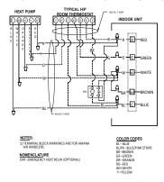
SYSTEM DIAGRAM - HEAT PUMP WITH TWO STAGE COMPRESSOR AND SINGLE STAGE ELECTRIC HEATER
