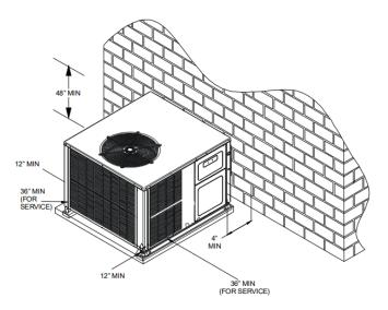
FIGURE 1: GROUND LEVEL INSTALLATION
