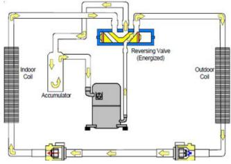
FIGURE 9: HEAT PUMP COOLING SCHEMATIC
